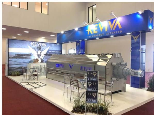
A Prensa Parafuso é um equipamento que trabalha a baixíssima rotação, proporcionando baixas manutenções e consumo de energia extremamente baixo. O alto desempenho na desidratação é garantido pelo compactador na saída de lodo desidratado.
